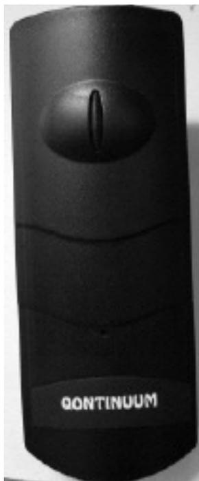
El Cabezal lector puede instalarse separado de la CPU hasta una distancia máxima de 10 metros si se utiliza un cable normal para comunicaciones (manguera de ocho conductores y malla) o hasta una distancia máxima de 100 metros siempre que el cable utilizado sea de pares trenzados con malla (STP) como el DIGILENE modelo COMPUTER A7C4 o el Belden modelo 1588 o cables similares.
